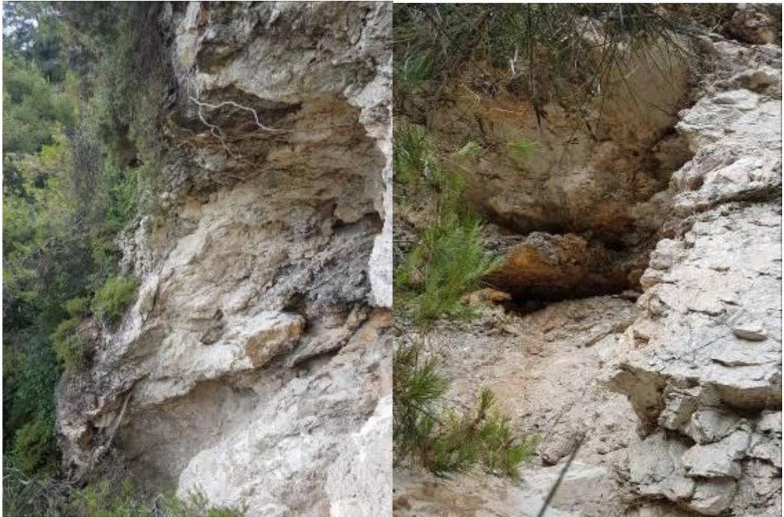
*Photo de la zone soucavée caractérisée par un calcaire dolomitique blanchâtre très altéré et présence de blocs et blocailles en pieds*
