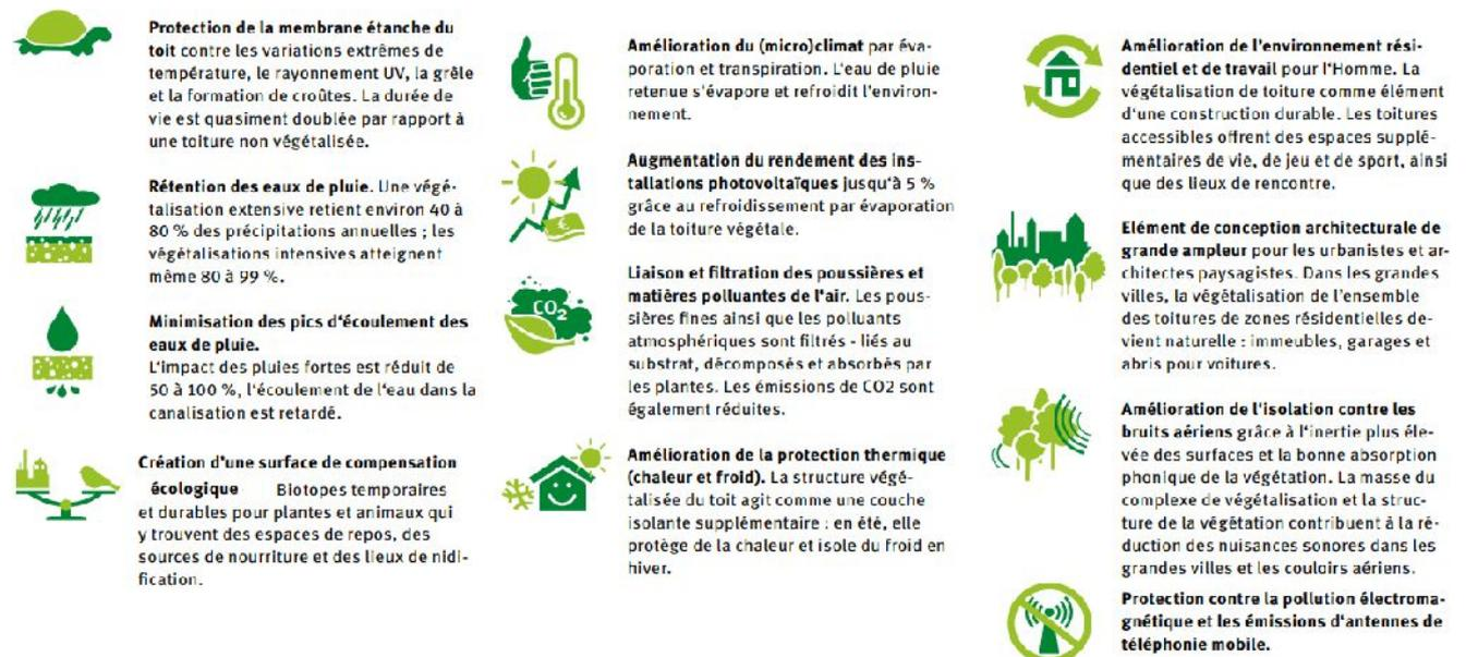
Figure 62 : Avantages des toitures végétalisées (source : Optigreen)
